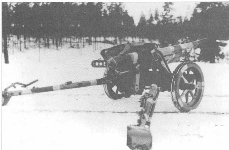
Ranskalais-saksalainen 75 mm:n panssarintorjuntakanuuna m/97-38 sai Suomessa lempinimen "mulatti". Kuva: Sotamuseo.
