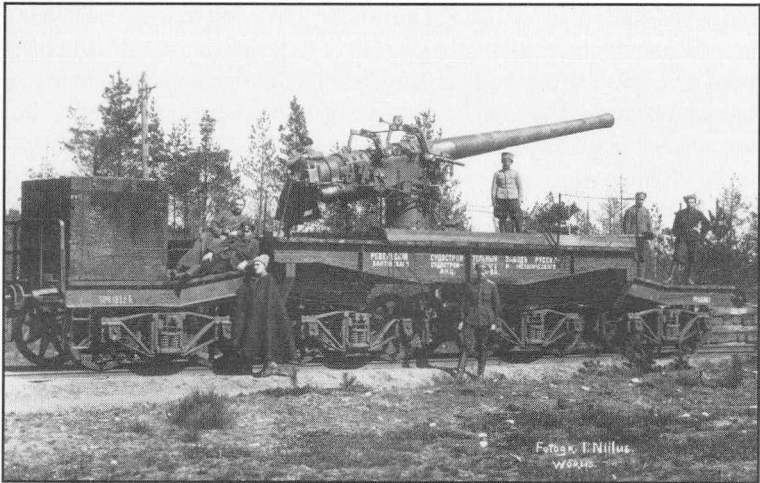
Panssarijuna nro 5, jonka aseistuksena oli mm. 130 mm:n laivatykki "Rasputin", Etelä-Virossa kesällä 1919. (Kuva: Sotamuseo)
