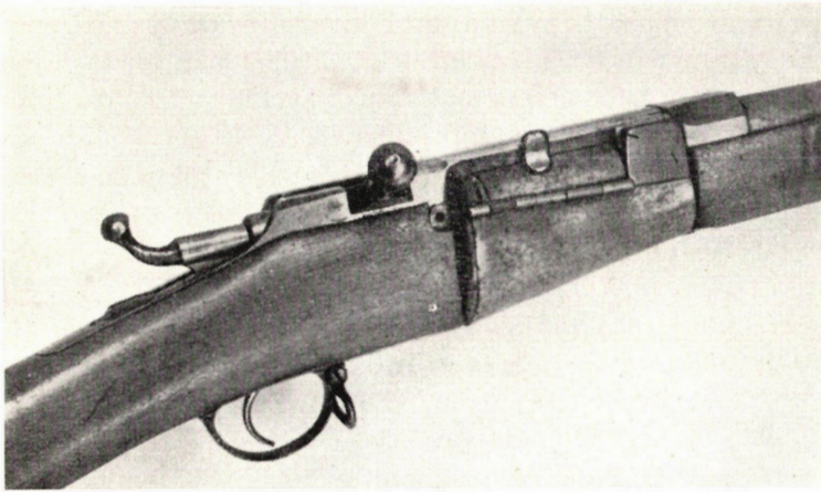
Kuva 6. Sotamuseossa olevan Hackstedtin kiväärin lukkolaite ja syöttökotelo. Mechanism and feeding device of Hackstedt's rifle.
