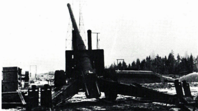
122K/31. Neuvostoliittolaista valmistetta. Paino tuliasemassa 7,1 tonnia, kantama 21 km. Kenttätykistön kauaskantoisin tykki. Niitä oli käytössä kesällä 1944 muutama kappale.
