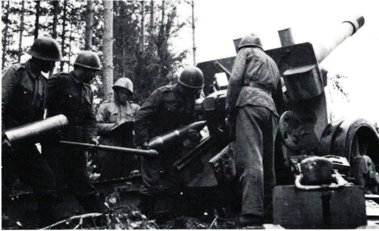
152H/37. Kauaskantoisin raskas haupitsi. Neuvostoliittolaista alkuperää. Paino tuliasemassa 7,1 tonnia, kantama 16,4 km.
