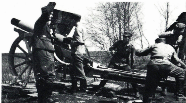
122H/10-30. Venäläistä alkuperää. Saman tykin eri muunnokset 122H/10, 122H/09-30 ja 122H/09-40 olivat yleisimmät kevyet haupitsit. Paino tuliasesassa 1,5 tonnia. Kantama 8,7 km.
