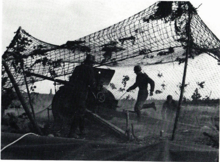
76K/36. Neuvostoliittolaista valmistetta. Oli käytössä vain 20—30 kappaletta. Paino tuliasemassa 1,6 tonnia. Tykillä oli kevyen kenttätykistön suurin kantama, 13,1 km.
