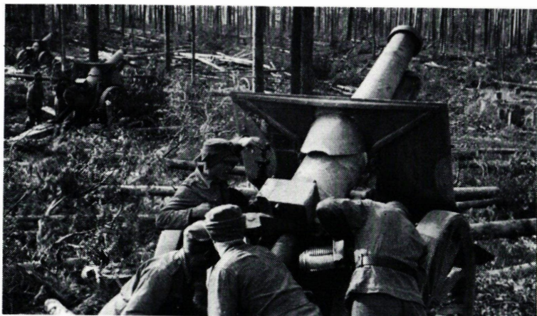
155H/17. Sodan loppuvaiheen yleisin raskas haupitsi. Ranskalaista alkuperää. Paino tuliasemassa 3,6 tonnia, kantama 11 km.
